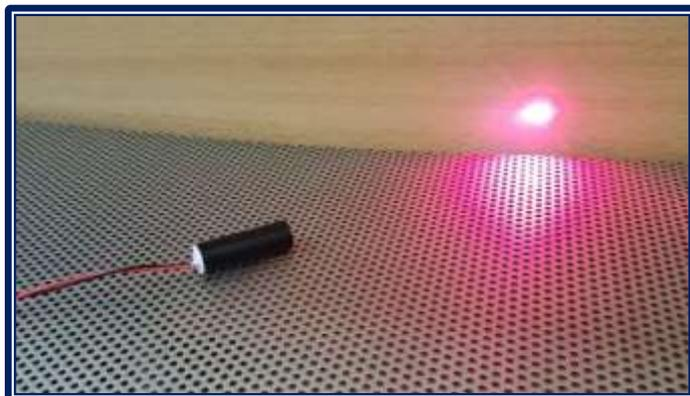
Лазерный диодный (полупроводниковый) модуль, излучающий в красной области спектра (650 нм). Отличается небольшими габаритами. Применяется для разметки и целеуказания.
