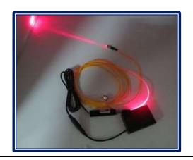
Лазерный диодный (полупроводниковый) модуль, излучающий в красной области спектра (650 нм), с возможностью ввода излучения в оптоволокно. Отличается небольшими габаритами. Применяется для разметки и целеуказания.
