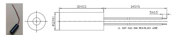
Лазерный диодный (полупроводниковый) модуль, излучающий в красной области спектра (650 нм), с разверткой точки в тонкую линию. Отличается малыми габаритами и изоляцией корпуса. Применяется для разметки в деревообрабатывающей, строительной и других видах промышленности.
